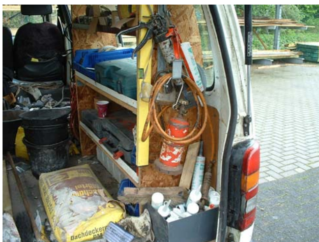
Kleinstflasche (Handwerkerflasche) ungesichert, nur am Ventil mit einem Haken aufgehängt; fehlender Schutzkasten, weitere Ladung ungesichert
