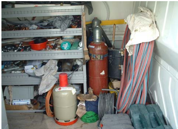
Acetylen- und Sauerstoffflasche durch Zurrurt gesichert, jedoch keine Sicherung der Propangasflasche und der weiteren Ladung
