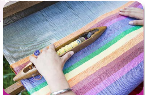
Abb. 2: Webvorgang mittels eines Webstuhls
